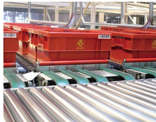
Über Sortierer werden die Kisten mit Post über 4 Ebenen zum ORM transportiert
