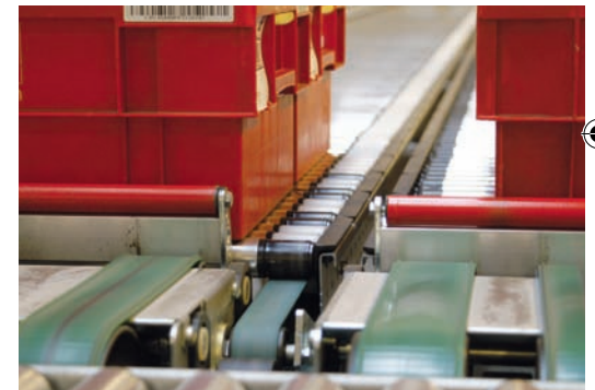
Der ORM arbeitet auf Basis von Frikionsantrieb. Die Rollen im System sind alle mit einem integrierten Ring ausgestattet und miteinander mit Riemen verbunden
