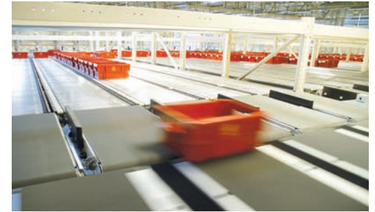
Sobald alle Kisten für ein Postleitzahlgebiet eingesammelt sind, werden sie an der Ausfahrseite entlassen. Die integrierte Dispenser-Einheit sorgt dafür, dass dies kontrolliert und schnell geschieht
