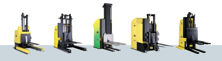
Ausführungen | Gabelhochhubwagen, Radarmstapler, Regalstapler, Schubmaststapler, Gegengewichtsstapler, Seitenschubstapler, Teleskopgabelstapler | Traglast | Standard bis 1.500 kg, Speziell bis 4.500 kg | Hubhöhe | 1.200 bis 3.000 mm | Sicherheitseinrichtungen | Schaltleisten, Laserscanner mit geschwindigkeitsabhängigem Warnbereich, Softbumper | Energieversorgung | Blei-, NiCd-, LiIon- oder LiFePo4-Batterien
