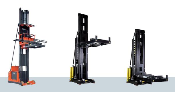
Lastträger | Teleskoptisch, Schwenkschubgabel | Übergabehöhe | 11 Meter Geschwindigkeit | bis 2,7 m/s | Traglast | bis 1,5 Tonnen | Sonderausstattungen | Lichtschranken-Lasterkennung, Konturenerkennung, Kameras am Kabinendach
