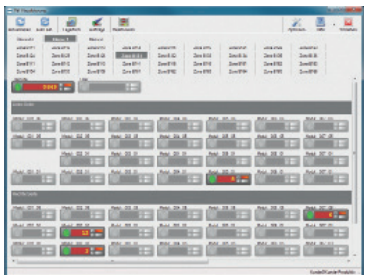
Pick-by-Light-Visualisierung einer Kommissionierzone im Leitstand
