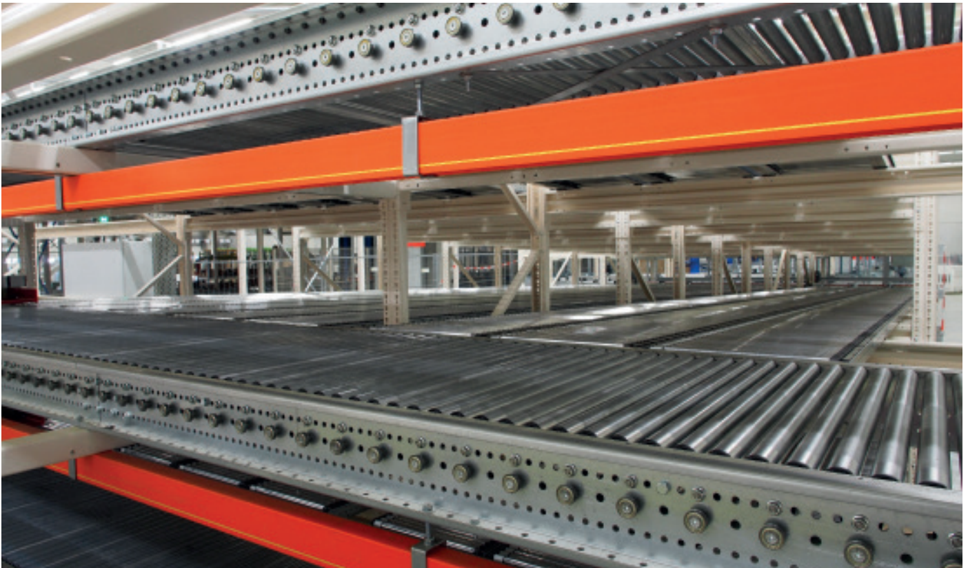
Herzstück des FLOWPICKER®-Systems ist der Fließkanalspeicher.
