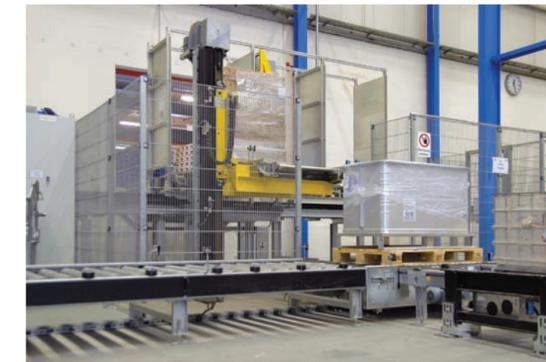
Die Doppel-Verschiebewagen übergeben die Paletten auf die Fördertechnik zur Einlagerung in die HRL-Gassen.
