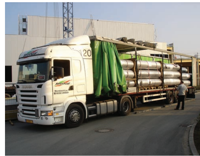
Neuentwickelter Ladungsträger mit Aufhänge-Funktion
