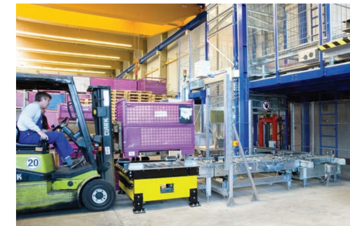
Die Palettenaufgabe im Wareneingang kann sowohl längs als auch quer erfolgen.
