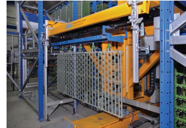
Auslagerung an einem der beiden Auslagerplätze mit Ziehvorrichtung
