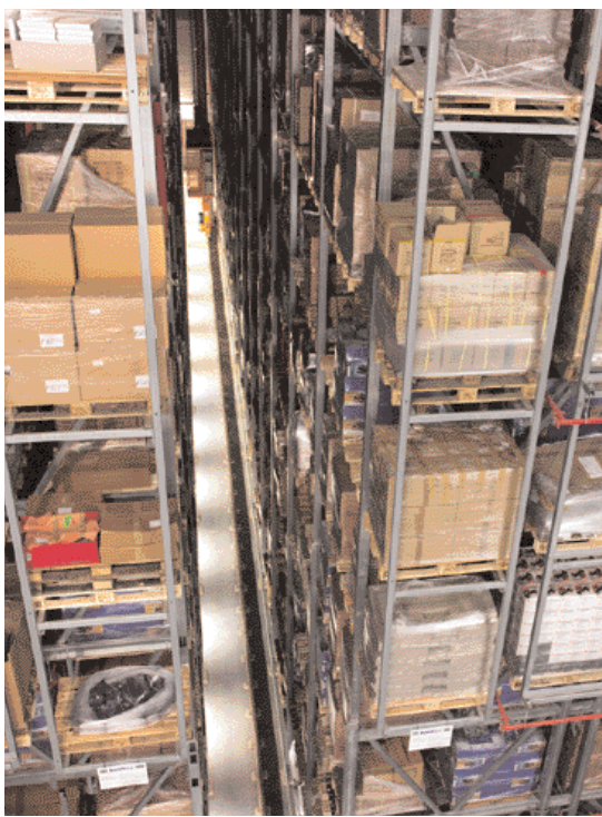
Das Palettenlager mit doppeltiefen Stellplätzen für nicht-behälterfähige Artikel.
