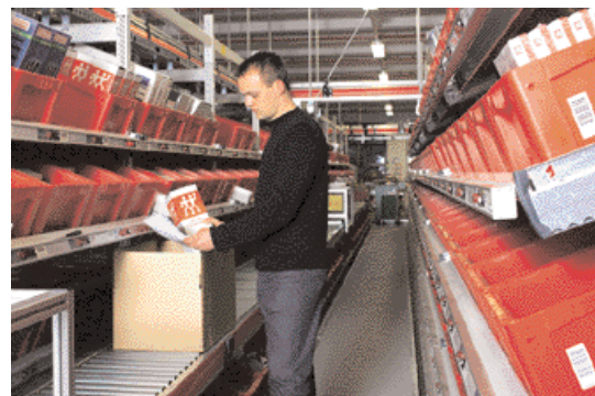
Hauptkommissionierzone mit Pick-to-Light-System. Die Belegung der 600 Plätze in den Durchlaufregalen war eine fast wissenschaftliche Arbeit.
