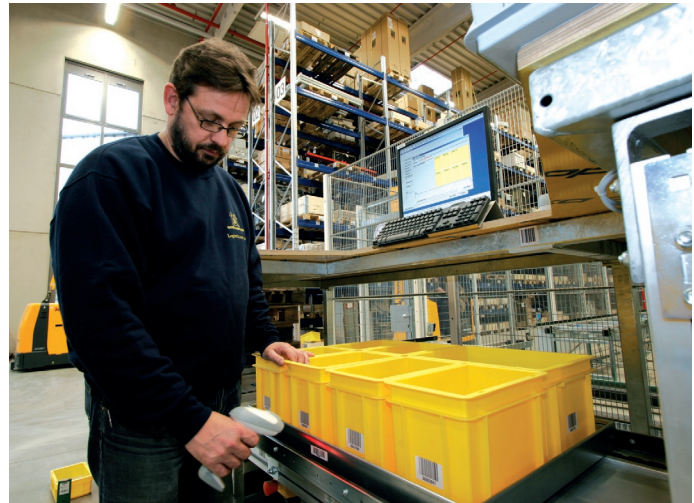
Bild: Per Scannung wird der Behälter mit dem Tablar „verheiratet“
