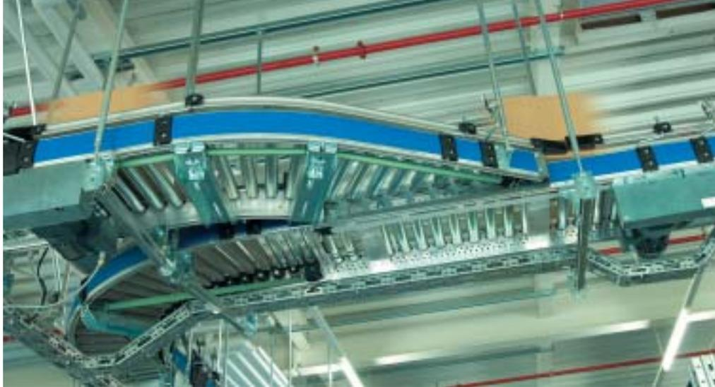
Die Fördertechnik läuft auf einer Länge von 580 m in 3,30 m Höhe und verbindet alle Lagerbereiche.
