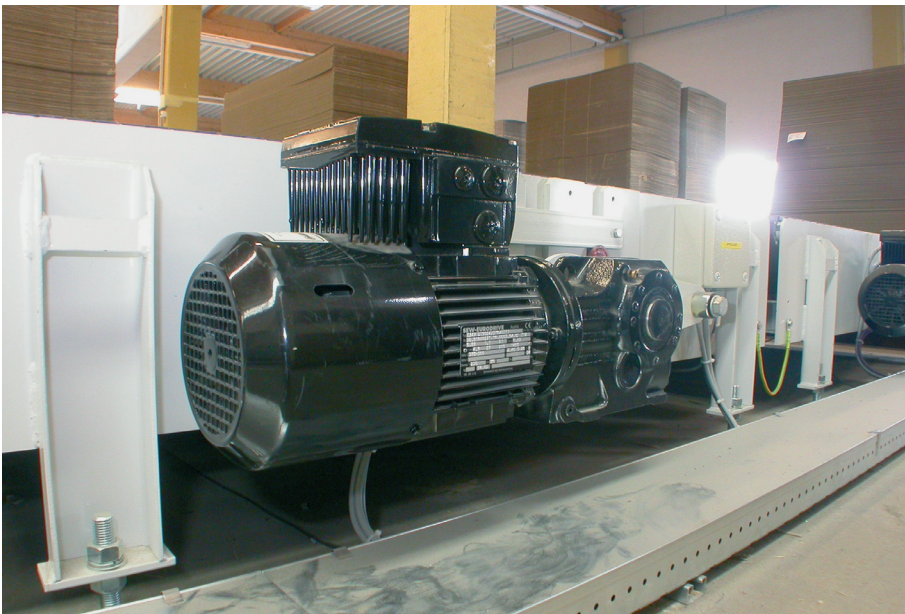
◀ Antriebseinheit von SEW – Motor, Getriebe und Umrichter sind eine Einheit.
