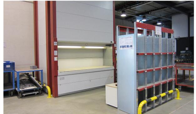
**Bild 2** Automatischer Turmspeicher für die kompakte Lagerung von Kleinstteilen.
