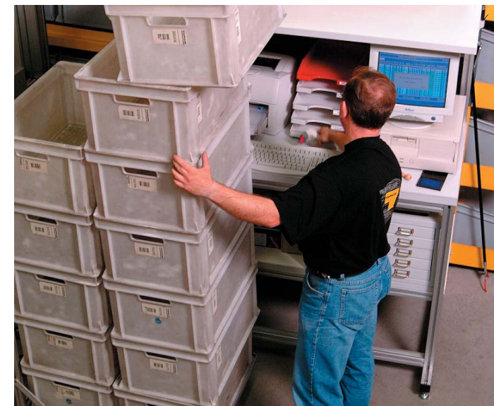
Vor dem Kommissionieren werden Kundenauftrag und Transportbox durch Scannen des Barcodes zugeordnet
