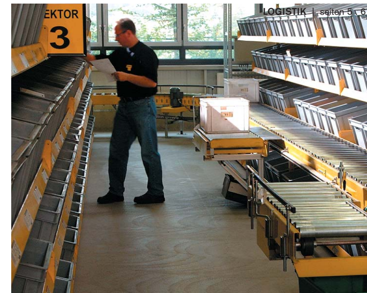
Hohe körperliche Belastungen entfallen. Die Boxen können entlang des Durchlaufregals auf Rollenbahnen bewegt werden.
