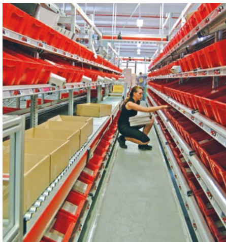
Bild 1: Automatisches Behälterlager mit seitlicher Kommissionierung und dynamischer Artikelbereitstellung
