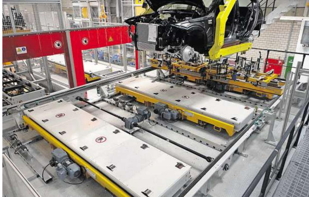
Exzenterhubtische mit Rollenbahnen, Querkettenförderer und EHB werden von Rofa-Lehmer entwickelt und eingebaut. Fotos: Rofa
