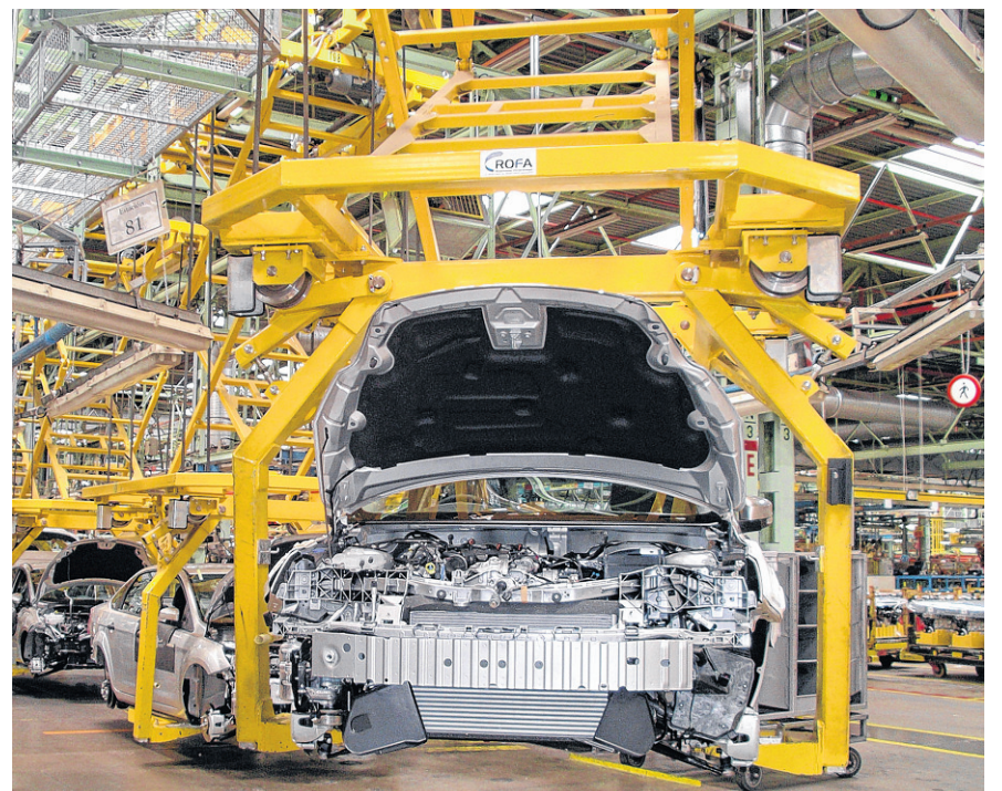
Produktbeispiel Hängefördertechnik: Elektrohängebahn in der Endmontage eines Automobilwerkes.
