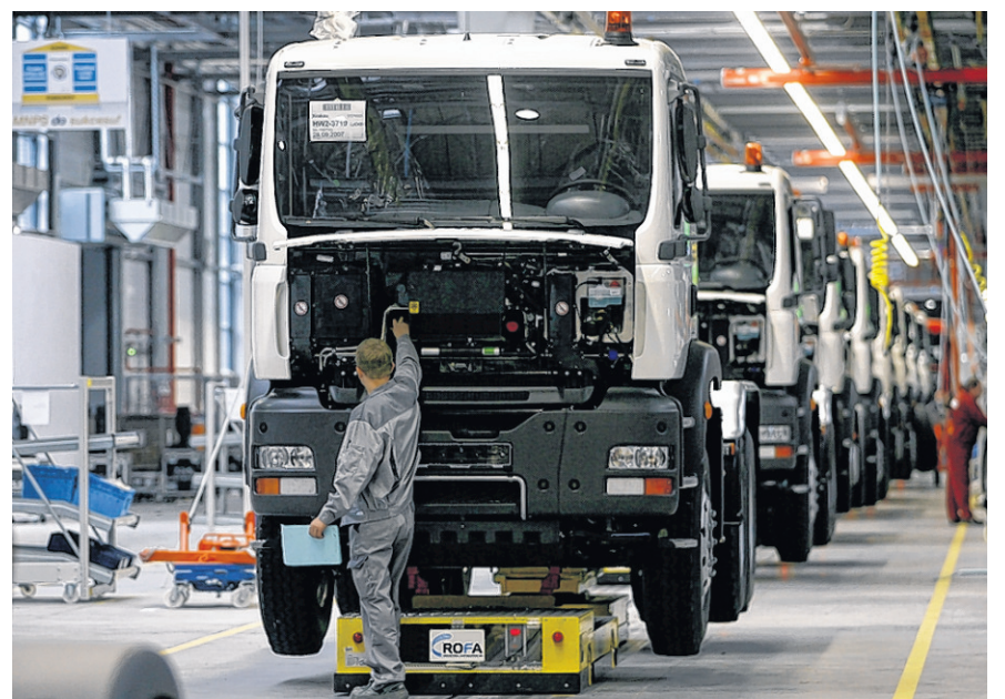
Produktbeispiel Bodenfördertechnik: Fahrerloses Transportsystem für den Transport von Lkw.
