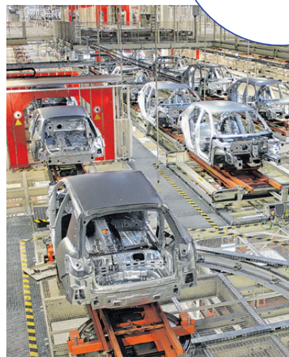
Bodenfördersystem im Rohbau eines Automobilkunden
