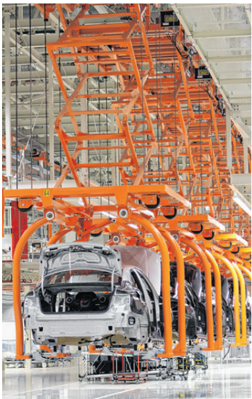
Schwerlast-Elektrohängebahnsystem in der Endmontage eines Automobilkunden
