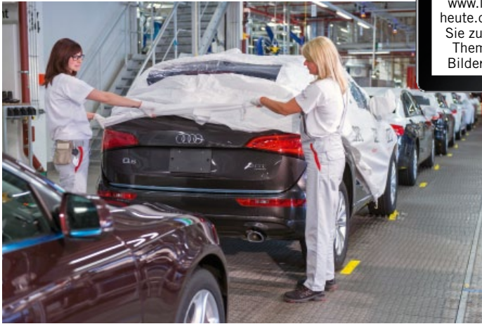
Zwei Mitarbeiterinnen beziehen einen Q5 mit einem Bodycover, damit der Wagen beim Transport geschützt ist.
