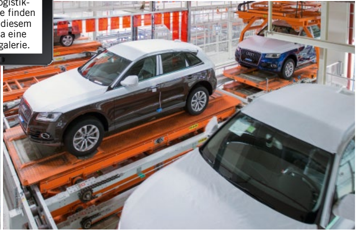
Die Fahrzeuge werden mit Greifern in das Zwischengeschoss gehoben. Dort werden sie auf sogenannte Skids umgeladen.
