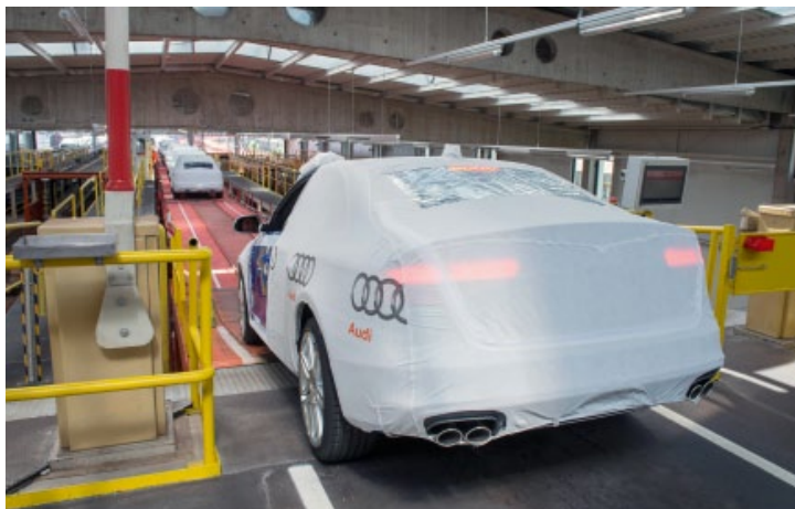
Das Schiebebühnensystem stellt automatisch leere Waggons für die Bahnverladung zur Verfügung.
